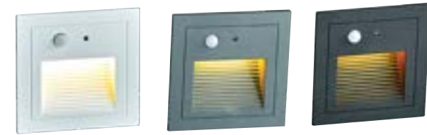
240-02-0036 발목 사각 매입 센서등 (9972) Size W84xD84XH32 타공 ø66X66 Lamp LED 3W / 3000K Color 화이트, 그레이, 블랙
