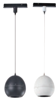
50-04-0116 마그네틱 에그 P/D(렌즈 조절형) Size Ø100×H100(10W) 반사각 10°~55° Lamp LED COB / 3000K, 4000K Color 흑색, 화이트 전원 DC 48V SMPS 별도사용 ※ 4000K는 주문제작 가능
