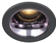
42-01-0058 3인치 레온 원형 매입등 Size W90XH78 /타공 ø73 Lamp LED COB 10W /삼색변환 Color 화이트,블랙
