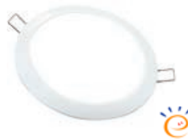
248-02 (15W) 6인치 고효율 다운라이트 일반형 D/C Size \phi 175 \times H 57 / 타공 \phi 150 Lamp LED 15W / 5700K Color 화이트
