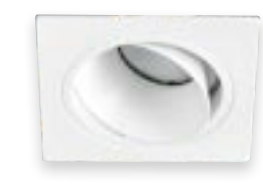
41-07-0056 3인치사각 회전 매입등 Size W93XH93 /타공 ø75x92 Lamp LED COB 15W / 3000K, 4000K Color 화이트,블랙
