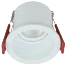
39-03-0016 COB2인치 홀컵 매입등 [9261] Size W70XH50 / 타공 ø57 Lamp LED 5W / 3000K, 4000K, 5700K Color 화이트
