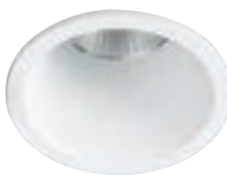
39-05-0024 COB 2인치 미니 직매입 Size W60XH87 / 타공 ø55 Lamp LED COB 7W / 3000K, 4000K Color 화이트
