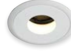
40-08-0056 3인치 OTS-5 매입등 (월와샤-원형) Size W84XH94 /타공 ø75 Lamp LED COB 20W / 3000K,4000K Color 화이트
