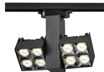
208-08-0132 에코 서치 COB 스포트 8구 레일 Size W205XD55XH185 Lamp LED COB 25 W / 3000K Color 블랙
