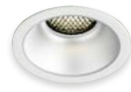
41-01-0036 3인치허니컴 매입등 (방습형) Size W85XH90 /타공 ø75 Lamp LED COB 15W / 3000K,4000K Color 화이트
