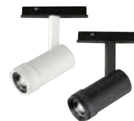
207-09-0084 모아 렌즈 스포트 (소) 렌즈조절형 Size ø47XH104 (175) Lamp LED COB10W / 3000K Color 화이트,블랙 / 반사각 10°~60° *4000K는 주문제작 가능
