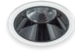
41-03-0024 3인치렌즈 매입등 (방습형) Size W85XH52 /타공 ø75 Lamp LED COB 10W / 3000K,4000K Color 화이트+블랙
