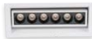
43-04-0088 미니6구 회전 매입등 Size Size W136XD57xH56/ 타공W130XD45 Lamp LED COB 10W /삼색변환 Color 화이트 *블랙은 주문품
